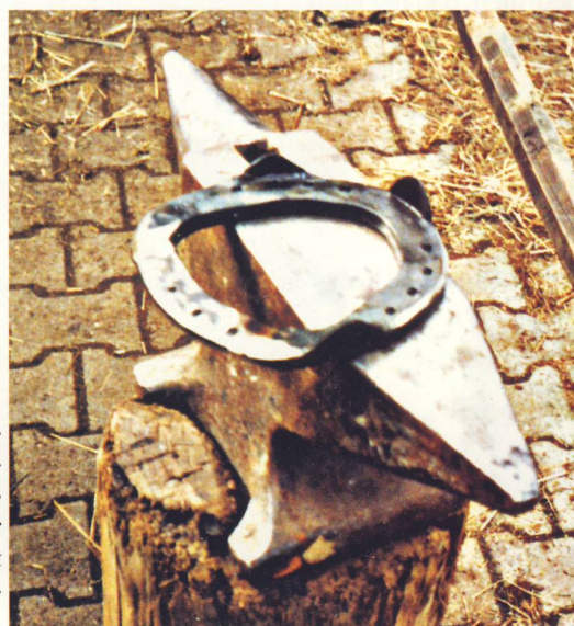
Medizinisch erforderliche zeitweise Ruhigstellung des Hufmechanismus derselben Fraktur mittels Eiereisen mit weit hinten angebrachten Seitenkappen.
